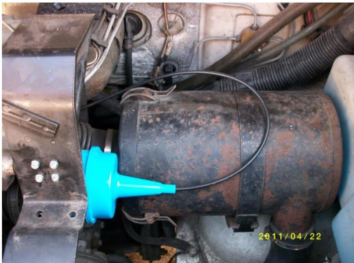
Damit der Stellmotor nicht am Luftfiltergehäuse klappert, wurde ein kleines Stück Schaumstoff zwischengeklebt. Der Bowdenzug wird in großem Bogen nach links zur Einspritzpumpe bzw. zum Gaszug geführt.
